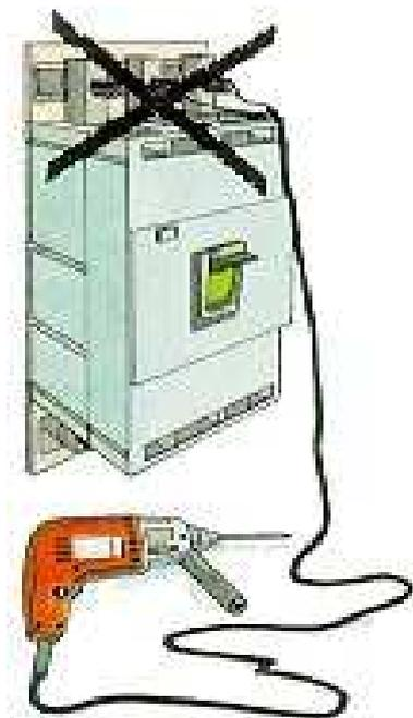
L'alimentazione degli utensili elettrici e delle lampade elettriche portatili, deve essere derivata da idonee prese. È vietato fare collegamenti di fortuna a sbarre, morsetti di interruttori, strumenti di misura, contatori, relè ecc.
