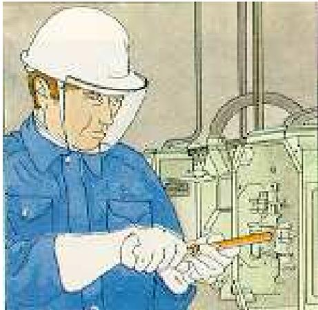
I lavori su installazioni elettriche in tensione e nelle loro immediate vicinanze sono vietati, quando la tensione è superiore a 25 V verso terra, se alternata, o a 50V verso terra, solo se continua.
